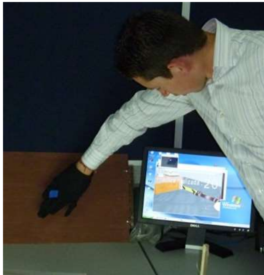
Figura 5. Uso del laboratorio virtual, se reconoce el movimiento de la mano y se transmite al mundo virtual.
