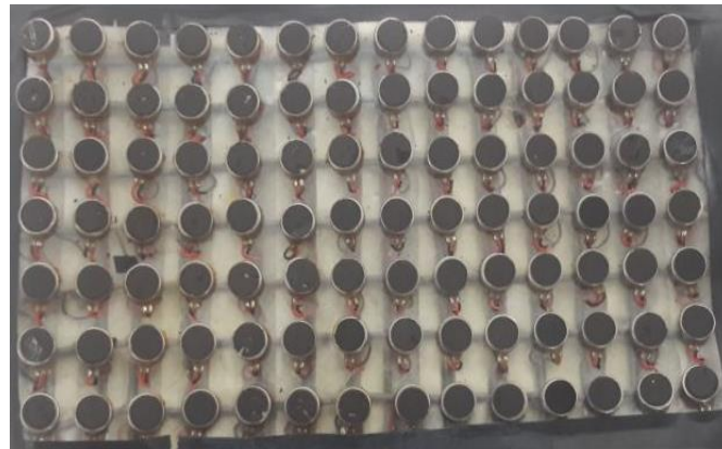
Figura 7. Matriz de micro motores 7x14 (98 micromotores).
