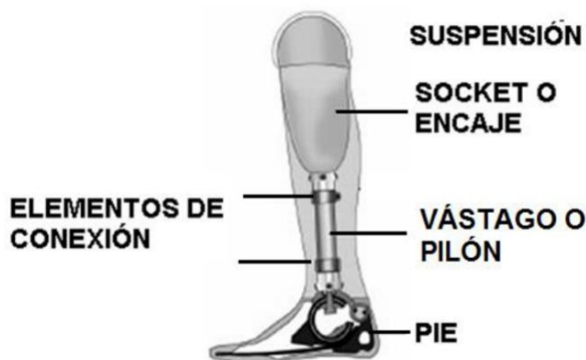
Figura 8. Prótesis transtibial y sus componentes. Adaptado de (AllBiz, 2019)
