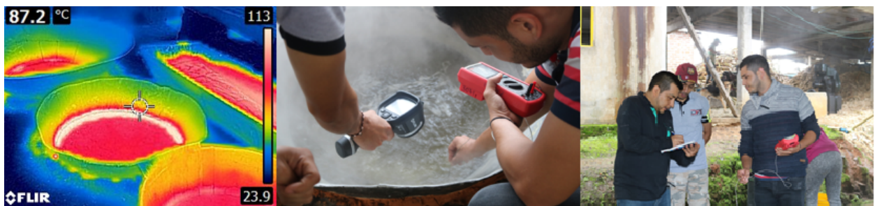
Ilustración 18 Toma de datos térmicos con pistola termográfica y termocupla
