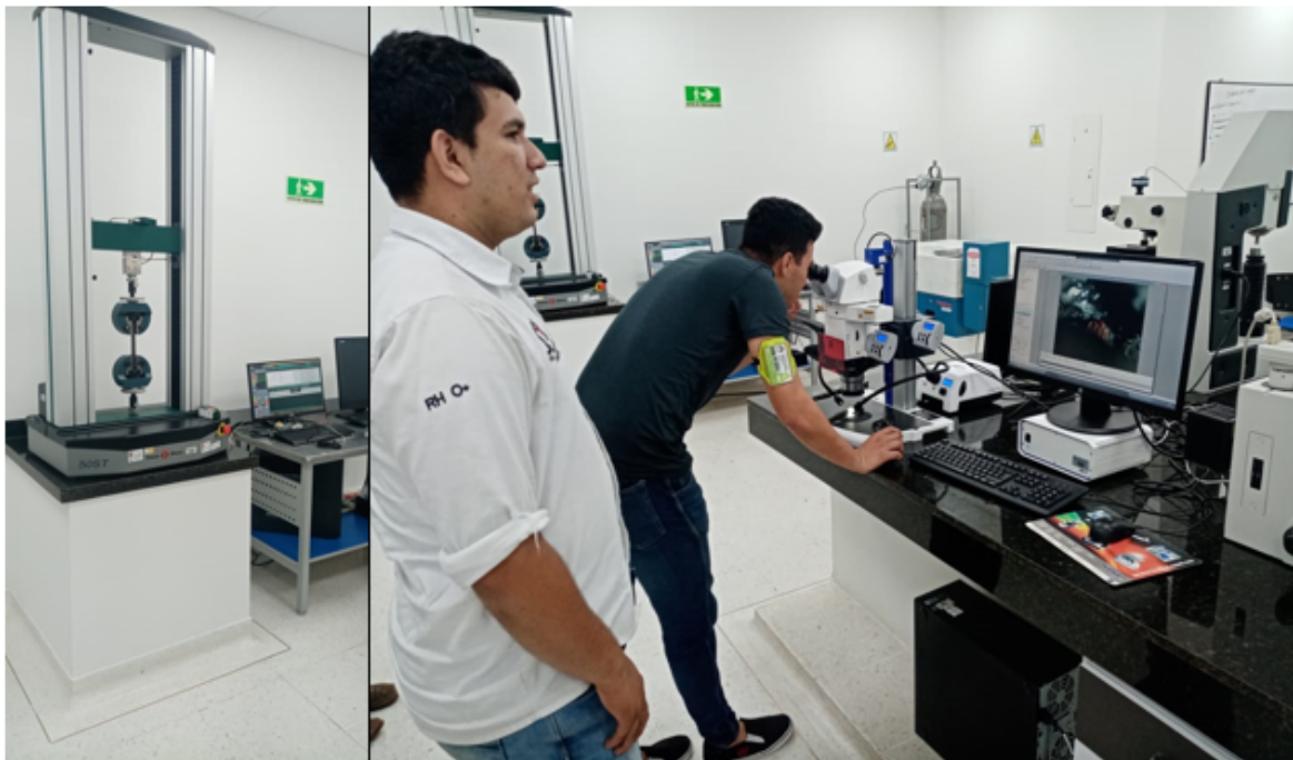
Ilustración 7 Equipos de laboratorio: Máquina Universal de Ensayos y Estereomicroscopio
