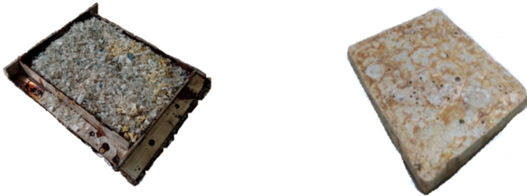
Ilustración 10 Molde y resultado final, baldosa en PET
