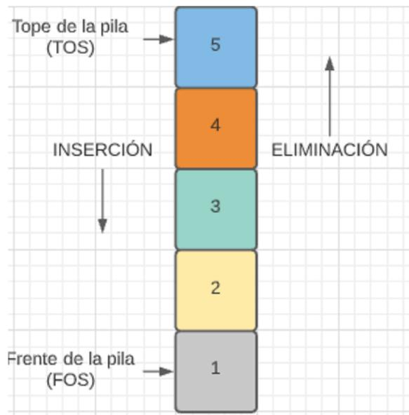
**Ilustración 16. Representación física de una pila**
