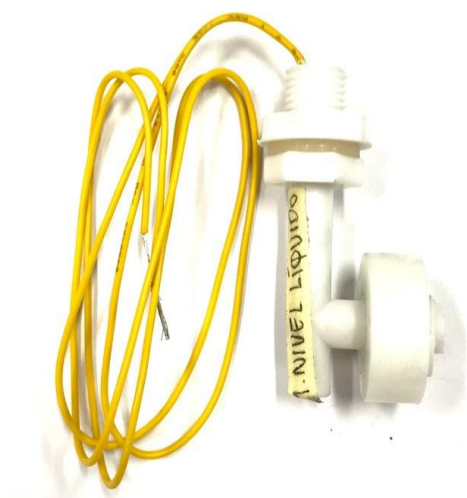
Figura 5. Ejemplo de etiquetado de dispositivos con el sensor de nivel de líquido. Elaboración propia.
