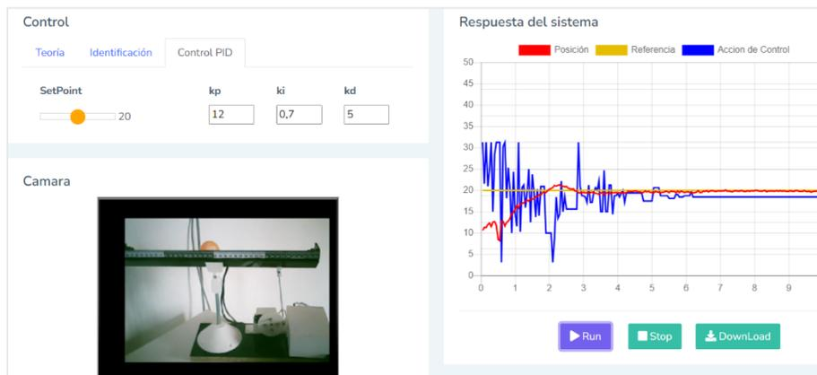
**Figura 5:** Resultado de ejecución del sistema para la verificación del controlador.
